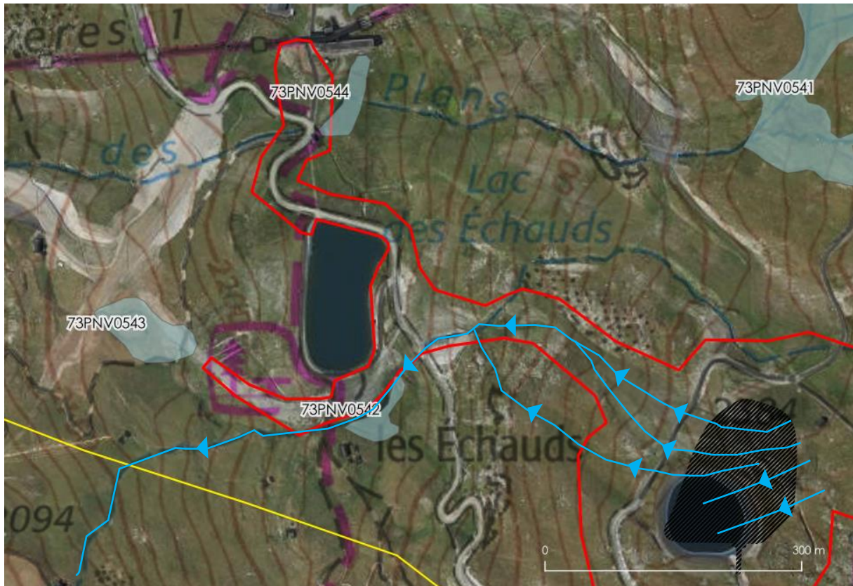
Circulation de l'eau de ruissellement sur la zone d'agrandissement projetée de la retenue des Echauds II
